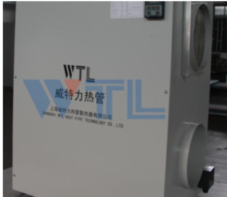
热管换热器的结构有别于其他形式的换热器。热管换热器具有一些明显特点：传热效率高，结构紧凑，换热流体阻力损失小，外形改变灵活，环境适应性强。
